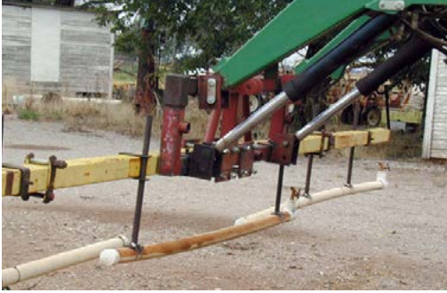
Şekil 6.9. Hatal-fital ve silecek uygulaması
