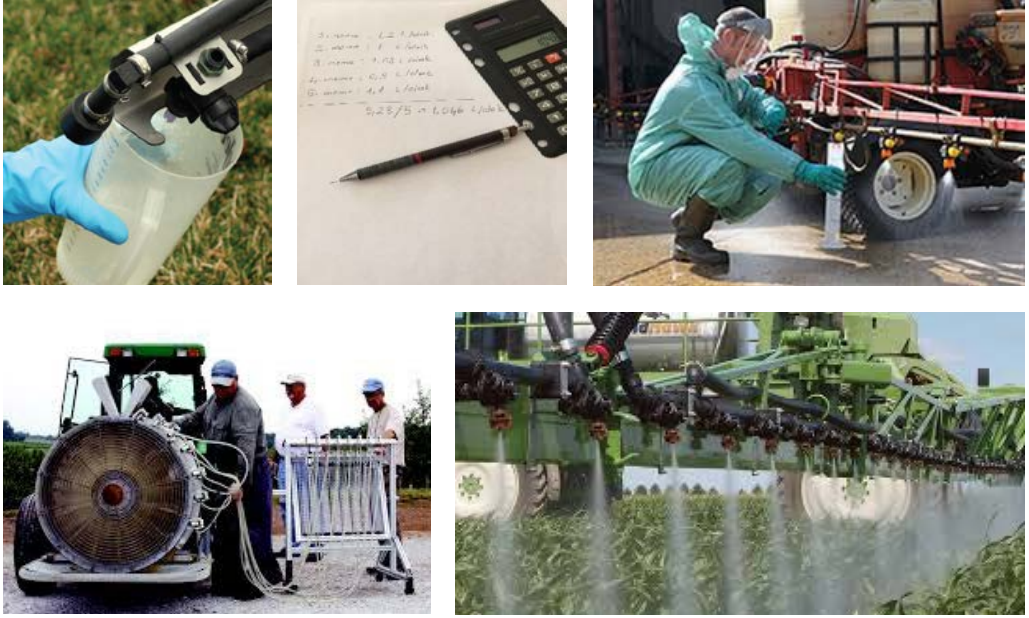
Şekil 6.24. Meme verdisinin belirlenmesi
