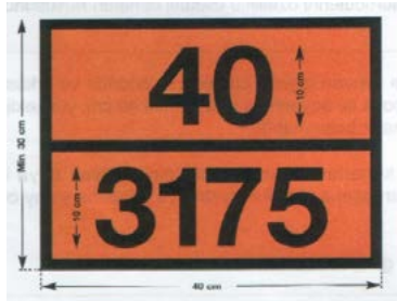
Şekil 5.3. Taşımada kullanılacak aracın önüne ve arkasına takılan yazılı turuncu levha örneği ve levhanın boyutları
