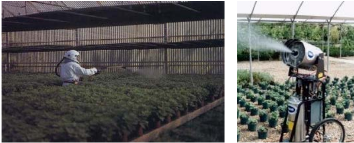
Şekil 7.11. Elektrostatik sera pülverizatörleri (Kabassima and Parrela 1995)
