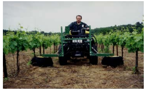
Şekil 7.14. Döner diskli memeli yabancı ot ilaçlama makineleri (Micron sprayer)
