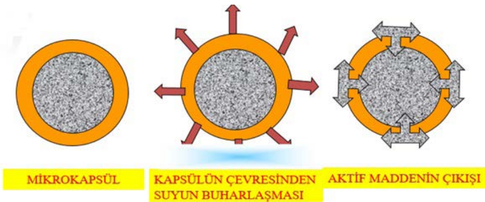
Şekil 3.4. Kapsül süspansiyon CS formülasyonun çalışma prensibi
