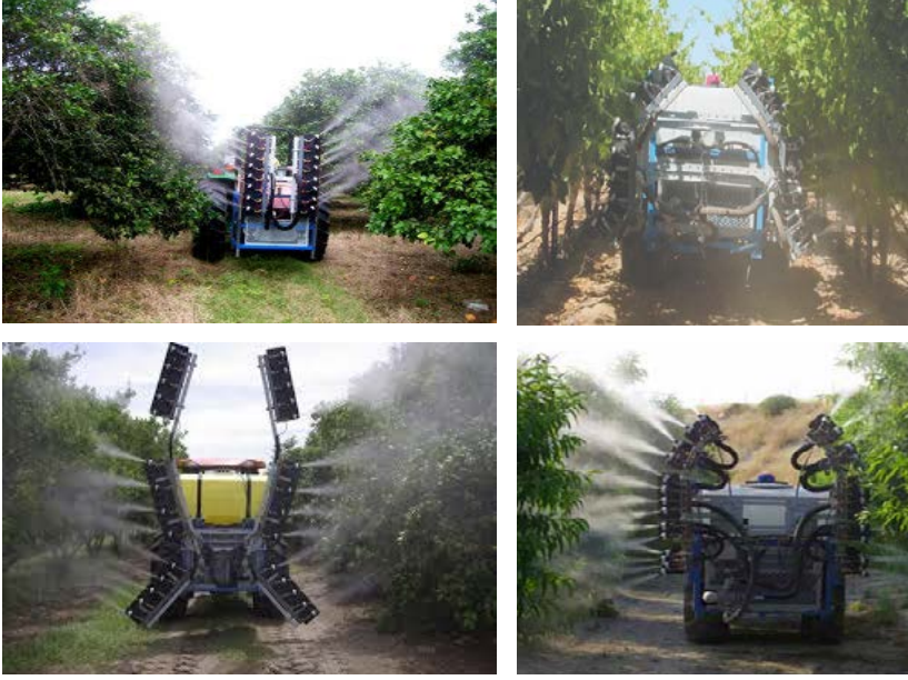
Şekil 7.9. Elektrostatik bağ-bahçe pülverizatörleri (ESS sprayer)
