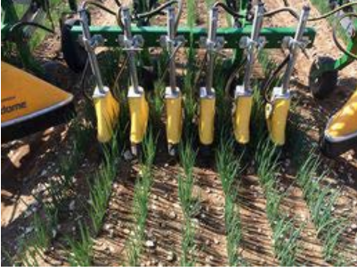
Şekil 7.15. Döner diskli memeli sıra arası yabancı ot ilaçlama makineleri (Micron sprayer)
