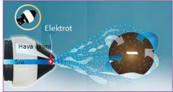
Şekil 7.7. Elektrostatik pülverizasyon tekniği
