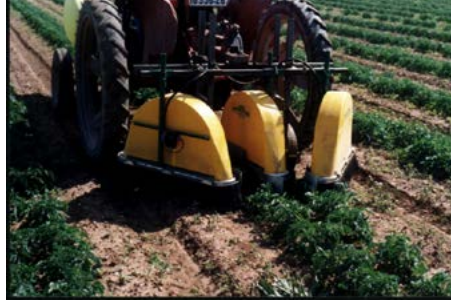
Şekil 7.15. Döner diskli memeli sıra arası yabancı ot ilaçlama makineleri (Micron sprayer)
