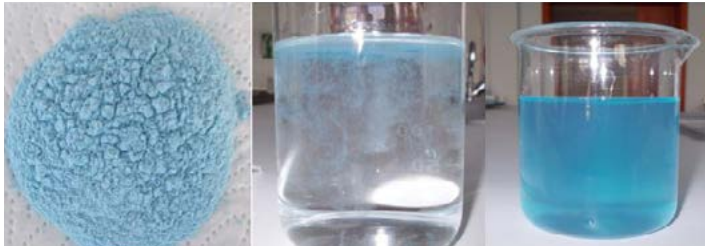
Şekil 3.8. SP formülasyon ve su ile karışması
