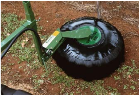
Şekil 7.14. Döner diskli memeli yabancı ot ilaçlama makineleri (Micron sprayer)
