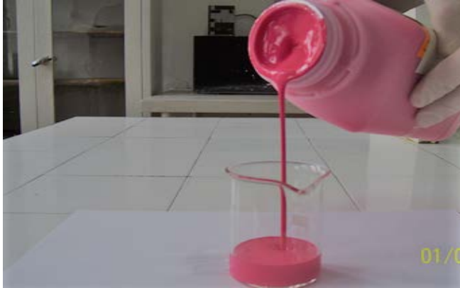
Şekil 3.5. Tohum ilaçlaması için akıcı konsantre formülasyon
